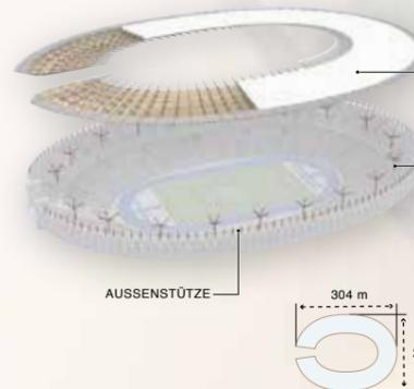
Das neue Stadionsdach ist mit einer beschichteten Glasfaser-membran überzogen. Die darunterliegende Stahlkonstruktion hat ein Gewicht von ca. 3.500 t. Das gesamte Dach wird dabei von 20 Dachstützen und 132 Außenstützen getragen.
